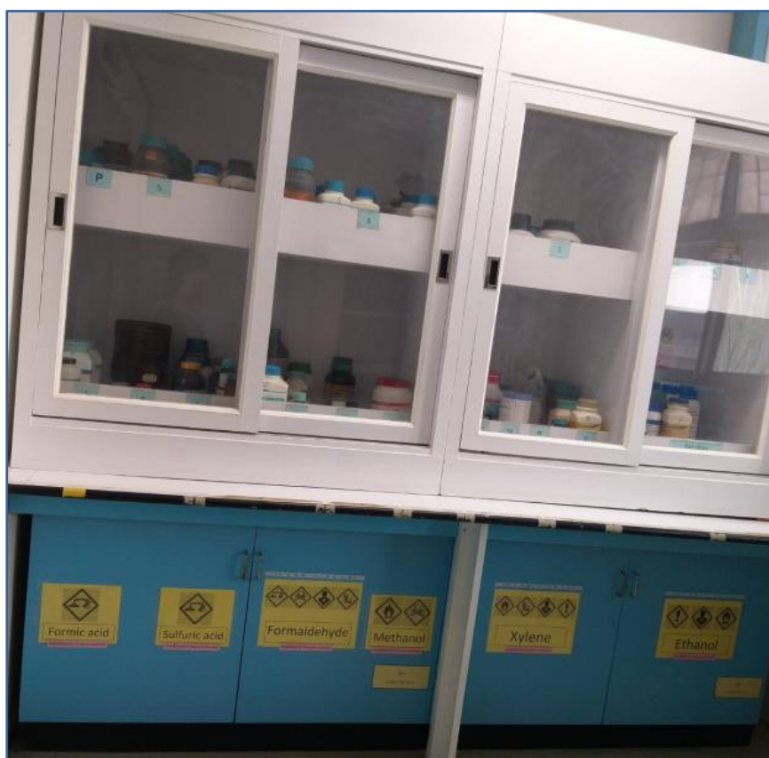
ภาพที่ 10 แสดงชั้นวางสารเคมีห้องเก็บสารเคมีของห้องปฏิบัติการ หลังยกระดับมาตรฐานความปลอดภัย
