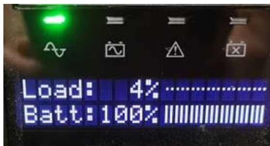
ภาพที่ 9 หน้าจอแสดงสถานะของเครื่องสำรองไฟ
