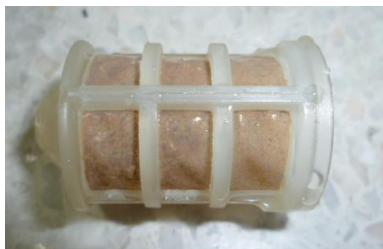
ภาพที่ 70 สภาพ Filter ระบบน้ำที่อุดตัน
