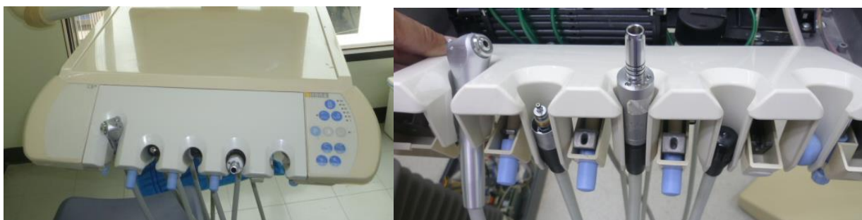
ภาพที่ 28 ตำแหน่งแผงปุ่มกดและ Holder Handpiece ที่ใช้ตรวจสอบระบบ Chair lock system
