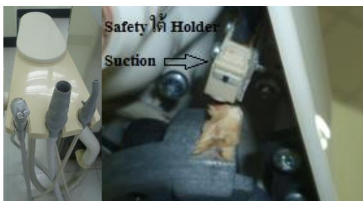
ภาพที่ 30 แสดงตำแหน่ง Safety ที่ติดตั้งไว้ใต้ Holder Suction
