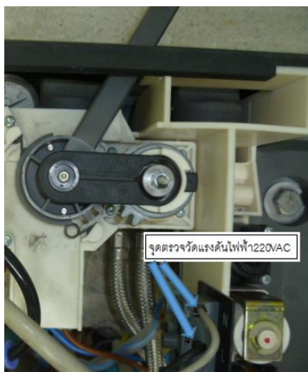
ภาพที่ 26 จุดตรวจวัดแรงดัน 220VAC
