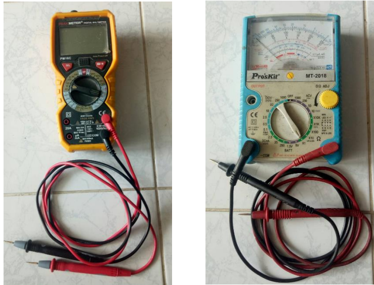
ภาพที่ 6 เครื่องวัดมัลติมิเตอร์(Multimeter)แบบเข็มและแบบดิจิทัล
