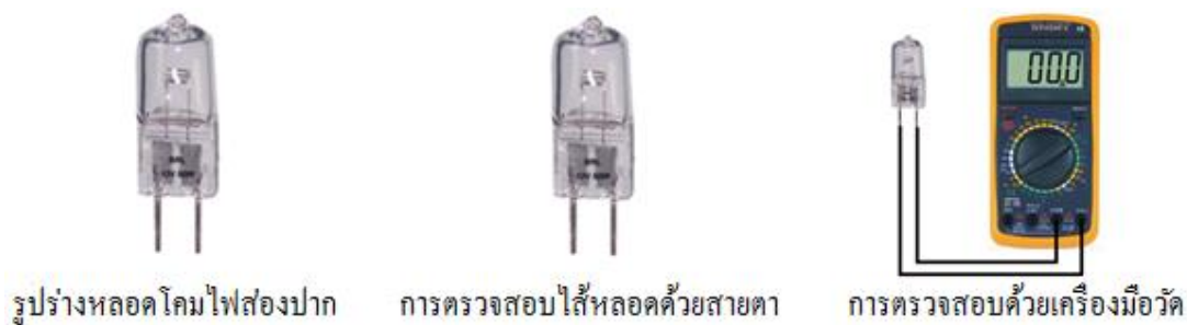
ภาพที่ 50 การตรวจสอบหลอดโคมไฟส่องปาก
