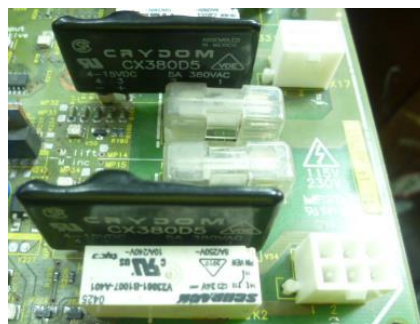
ภาพที่ 40 รูปร่างโซลิดสเตตรีเลย์ (Solid state Relay) ที่ใช้ในแผงวงจรหลัก ( Mainboard )
