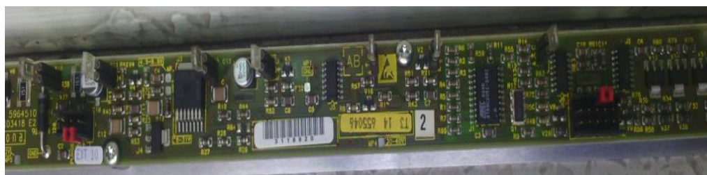
ภาพที่ 22 แผงวงจรควบคุมด้ามกรอฟัน ( Handpiece )
