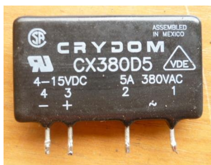
ภาพที่ 40 รูปร่างโซลิดสเตตรีเลย์ (Solid state Relay) ที่ใช้ในแผงวงจรหลัก ( Mainboard )
