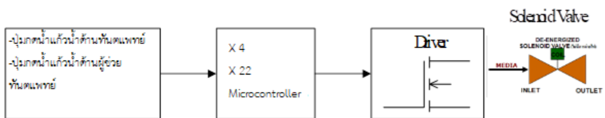
ภาพที่ 43 การเชื่อมต่อสัญญาณของระบบควบคุมนํ้าแก้วนํ้าสำหรับบ้านพักคนไข้
