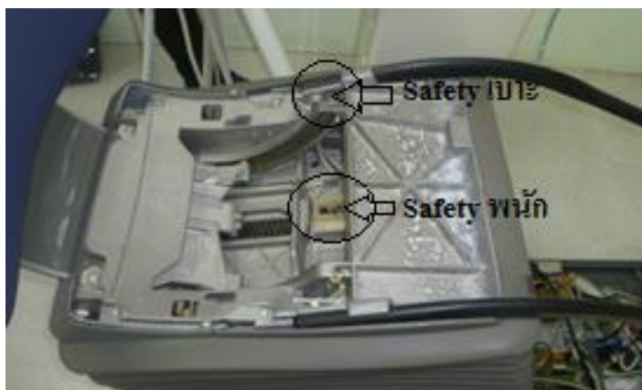
ภาพที่ 31 แสดงตำแหน่ง Safety ของพนักพิง และเบาะรองนั่งของยูนิตทันตกรรม
