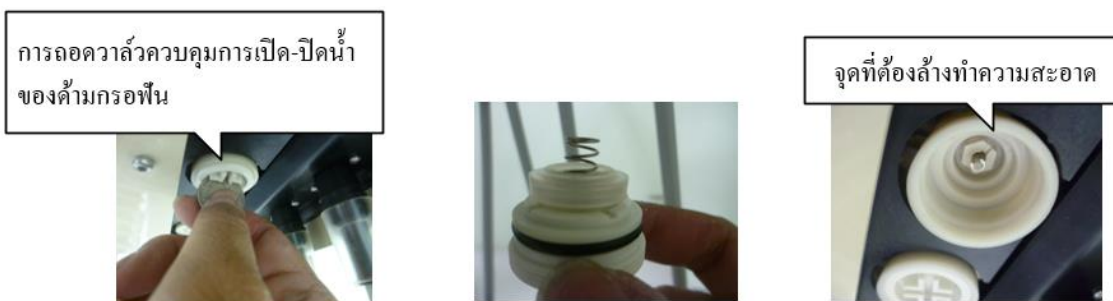
ภาพที่ 61 การถอดวาล์วควบคุมการเปิด-ปิดน้ำ ของด้ามกรอฟัน
