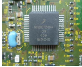
ภาพที่ 17 ไอซี Microcontroller เบอร์ MC68HC705B16N ที่ใช้ในยูนิต Sirona C8+
