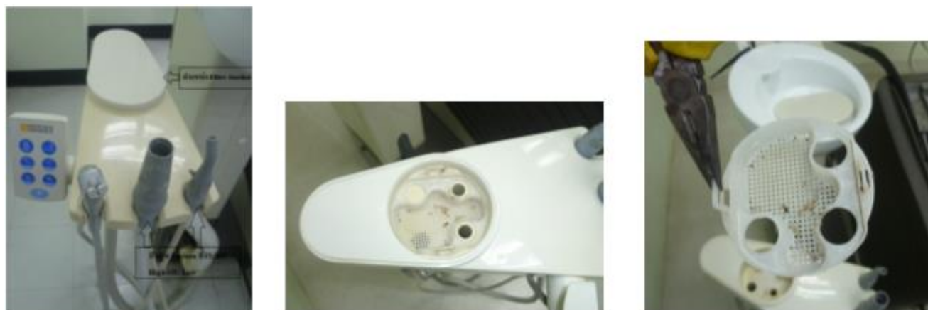
ภาพที่ 67 ตำแหน่ง Filter Suction ติดตั้งที่ Holder Suction
