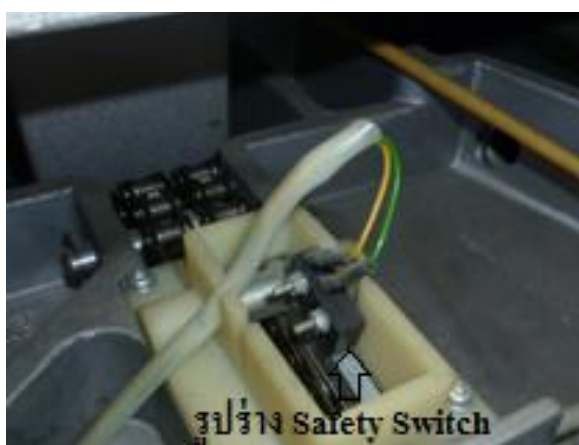
ภาพที่ 32 รูปร่างอุปกรณ์ Safety Switch
