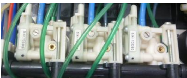
ภาพที่ 60 อุปกรณ์ควบคุมระบบน้ำและระบบลมของด้ามกรอฟัน
